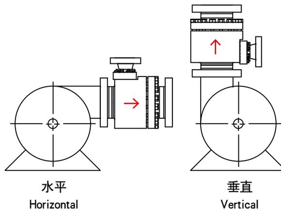
自控回流阀既可垂直安装又可水平安装, 旁路安装方向任意, 但水平安装时旁路不能向下。自控回流阀一般安装在泵出口法兰, 介质流动方向必须和箭头方向一致。
