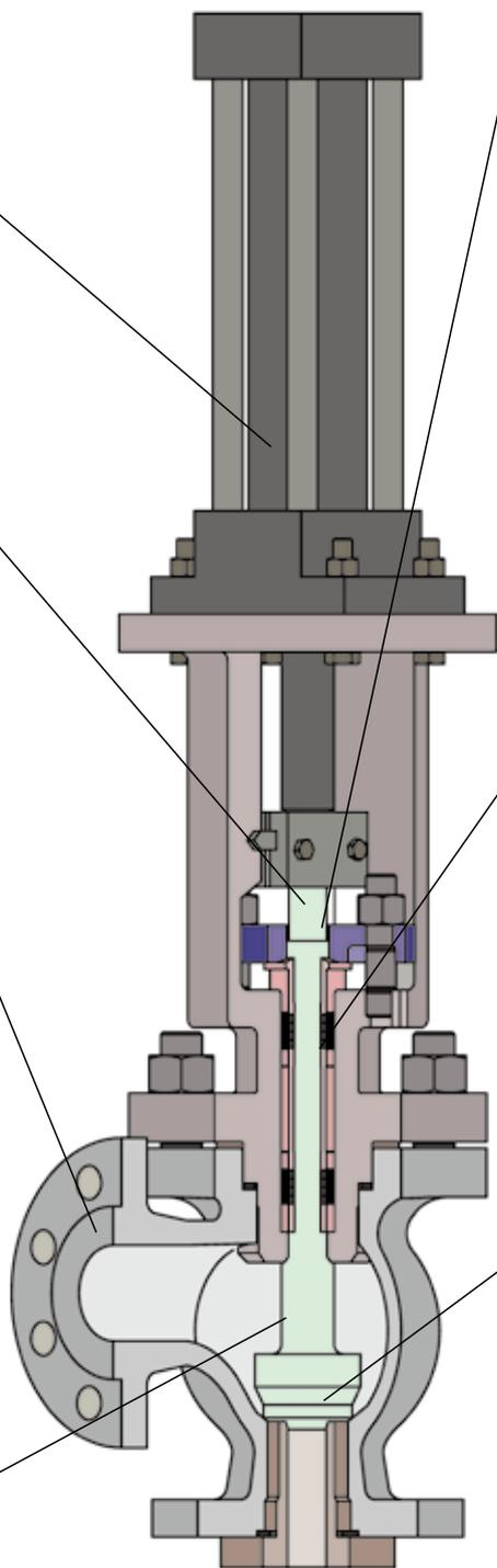
上导向套采用柔性结构，有效抑制阀杆振动。
